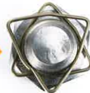
ボルトにペタルファスナーを装着 外形が三角形から六角形に変位。 ネジ部に緊縮力が発生し、ナットの 脱落を防止します。
