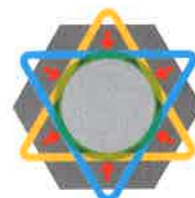
ナット面をスプリング3辺で圧接。 ネジ部緊縮力との合成力発生。
